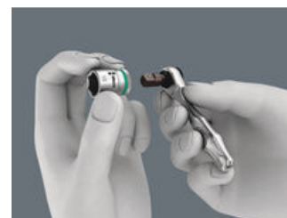
Bits och hylsor. Bits kan jag sätta på direkt. Jag kan också välja att först sätta i en hållare, och sedan en bit. Den fungerar även som förlängning med fritt roterande styrhylsa. För hylsor behöver jag en adapter 1/4" sexkant till fyrkant, t.ex. Wera 870/1 (ingår i Bit-Check och i satser med bitsspärrhandtag).
