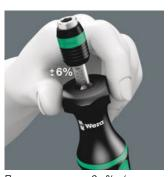
Погрешность  $\pm$  6 % (артикль 1430:  $\pm$  10 %) по стандарту DIN EN ISO 6789. Слышимый и ощущаемый щелчок по достижении установленного крутящего момента.
