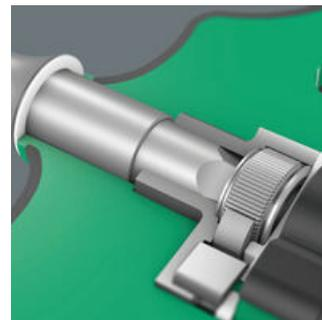
Встроенная трещотка с тонким механизмом зацепления (80 зубцов) и углом возврата 4,5° упрощает и ускоряет закручивание без нудных повторных накидываний. С быстрозажимным патроном Rapidaptor под биты 1/4".
