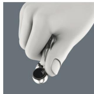
Штампованная, цельнометаллическая трещотка для работы с битами. Тонкий механизм зацепления на 60 зубцов обеспечивает малый угол возврата 6° для точности работы. Просто работать в ограниченном пространстве одной рукой. Рифлёный диск помогает быстро закручивать крепёж, когда для трещотки мало места. Под биты 1/4". С помощью адаптера Wera 870/1 возможно использование также головок 1/4".
