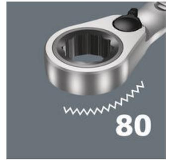
Конструкция трещотки в накладной части ключа с необычайно тонким механизмом зацепления на 80 зубцов для свободы действий даже в тесном пространстве.
