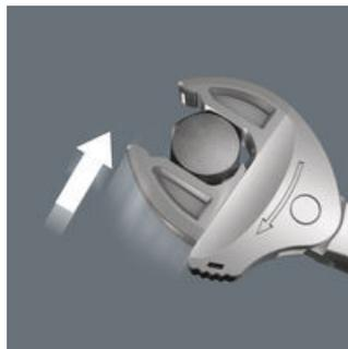
За счёт автоматического и плавного зажима параллельно перемещающихся губок рожковый ключ Joker 6004 подходит для всех размеров в соответствующем диапазоне. Ключ сам и без регулировки выбирает нужный размер при накидывании на гайку или винт.
