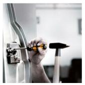
Отвертки часто используют вместо стамески. Это неправильно и опасно. Если вам нужно не только завинчивать, поможет отвертка-резец. Для завинчивания, выдалбливания, отжимания И освобождения прочно сидящих винтов. Отвертка-резец 0T Wera инструмент для особо сложных случаев!
