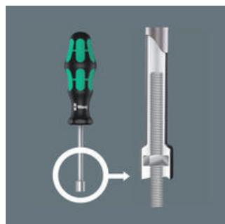
При навинчивании на резьбовые шпильки понадобится отвёртка с полым стержнем, т.к. проходящая сквозь навинченную гайку шпилька может войти только в полую отвёртку.
