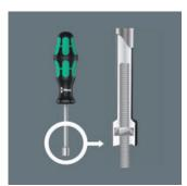
Если нужно навинтить гайку на резьбовую шпильку, то потребуется отвертка с полым стержнем, т. к. выступающая сквозь гайку шпилька может входить только в полость.
