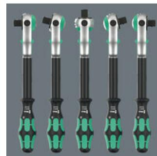
Головка трещотки свободно поворачивается и благодаря расположенным с обеих сторон подвижным переключателям может блокироваться в любом положении. Таким образом, даже в узких и труднодоступных местах Вы можете выполнять работы без проблем и достаточно свободно. Фиксация в определенных положениях под углом 0°, 15° и 90° влево и вправо гарантирует уверенную работу с надежно зафиксированной трещоточной головкой.
