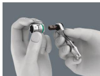
Биты и насадки можно устанавливать напрямую. Также сначала можно установить держатель, который будет фиксировать бит. Держатель также служит удлинителем с муфтой свободного хода. Для насадок понадобится адаптер 1/4" для перехода с шестигранника на квадрат, например, Wera 870/1 (имеется в наборе Bit-Check и с отдельными ручками-трещотками входит в комплект поставки).
