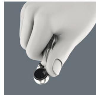
Zyklus Mini 1 может достичь высокой скорости работы. Для этого имеется ребристый диск, с помощью которого можно значительно ускорить заворачивание, поскольку сама ручка-трещотка для битов вступает в работу только при завершающей затяжке винта трещоткой.
