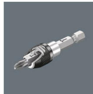
Быстрозажимной держатель обеспечивает прочное и стабильное соединение с насадкой, которое можно легко нейтрализовать. Держатель сконструирован таким образом, что для замены бита нужно просто сдвинуть внешнюю гильзу вперед, чтобы легко установить и извлечь насадку. С магнитом - для более легкого наживления винта.
