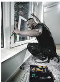
Используя отвёртку 393 S, можно работать с деталями, расположенными за препятствием. Гибкий стержень помогает добраться до крепежа, который находится в неудобном месте. Идеальный инструмент для завинчивания труднодоступного крепежа.
