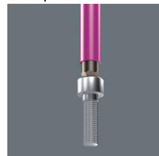
Поддержка винта с внутренним шестигранником на отвёрточной головке обеспечивается с помощью шарикового фиксатора. Это особенно помогает при работе в труднодоступном месте, куда для удержания винта не помещается вторая рука.
