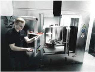
Поштучная проверка под напряжением 10000 В по стандарту IEC 60900 гарантирует безопасность работы под напряжением до 1000 В.
