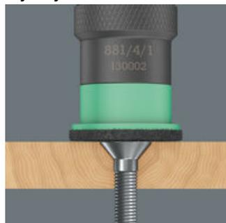
Битодержатель 881/4/1 служит для завинчивания крепежа заподлицо на одинаковую глубину в террасную доску. При необходимости глубина завинчивания регулируется. Так можно избежать слишком большого утапливания крепежа.
