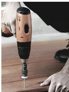
Битодержатель для завинчивания крепежа заподлицо на одинаковую глубину в террасную доску
