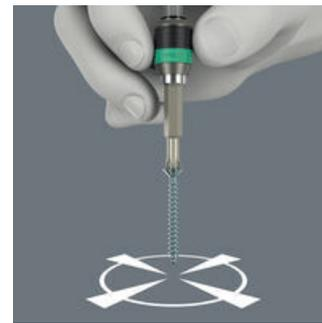
Удерживая муфту свободного хода, можно направлять аккумуляторный или электрический винтовёрт в процессе завинчивания. Это облегчает контакт инструмента с винтом и предотвращает соскальзывание бита. Держатель может служить в качестве короткого удлинителя с приводом 1/4", например, для трещотки Zyklop.
