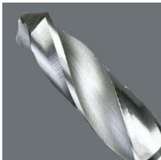
Насадка-спиральное сверло, для дерева - Привод 1/4" подходит для держателей в соответствии с DIN 3126-D 6,3 (ISO 1173) - Отличная передача усилия без потерь с помощью шестигранного тела - HSS = быстрорежущая сталь - Точно согласованная эластичность материала для долгого срока службы - Очень хорошая точность вращения - Насадки с закалкой до вязкой твердости и твердые насадки для особо долгого срока службы
