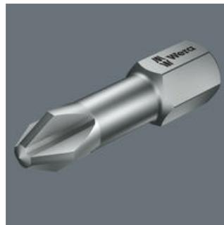
Насадки TZ - это насадки с закалкой до вязкой твердости. Насадки Torsion обеспечивают амортизацию пиков крутящего момента в зоне кручения. Это позволяет избежать преждевременного износа и продлить срок службы насадки.
