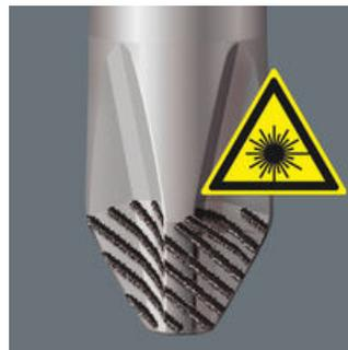
Узко сфокусированный луч лазера создает структуру поверхности с острыми кромками. Наконечник Wera Lasertip крепко "цепляется" за шлиц винта и предотвращает выскальзывание из него. Идеален для прямого шлица, Phillips и Pozidriv.
