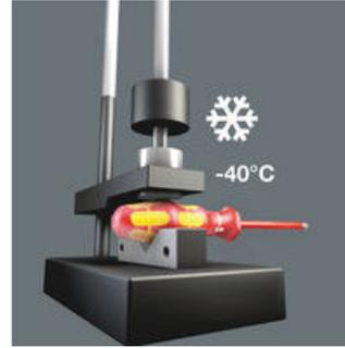
В экстремальных условиях применения безопасность также гарантируется благодаря проверенной ударопрочности при низких температурах -40 °С.
