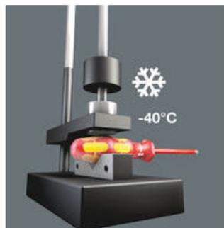
В экстремальных условиях применения безопасность также гарантируется благодаря проверенной ударпрочности при низких температурах -40 °С.
