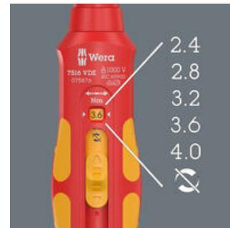
Пять выбираемых моментов затяжки (2,4; 2,8; 3,2; 3,6; 4,0 Нм) и одно фиксированное положение (Torque Lock) для неограниченного момента силы при ослаблении/затяжке крепежа.
