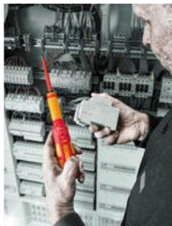
Динамометрическая ручка-держатель 7516 VDE с 5 предустановленными значениями крутящего момента (2,4; 2,8; 3,2; 3,6; 4,0 Нм)
