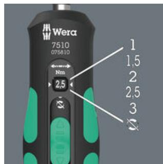
Пять значений момента затяжки по выбору (1,0; 1,5; 2,0; 2,5; 3,0 Нм) плюс одно фиксированное положение (Torque Lock) для приложения неограниченного момента силы при срывании/затяжке крепежа.
