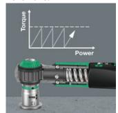
Динамометрический ключ Safe-Torque A 1 имеет проскальзывающий механизм срабатывания. При достижении выставленного момента затяжки ключ не перетягивает, что исключает приложение чрезмерного момента затяжки.
