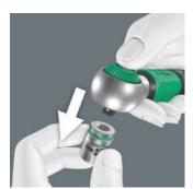
Шариковый фиксатор обеспечивает надёжную посадку головок и насадок, тем самым гарантируя надёжность процесса завинчивания. Короткое нажатие на деблокиратор трещоточной головки деактивирует шариковый фиксатор.
