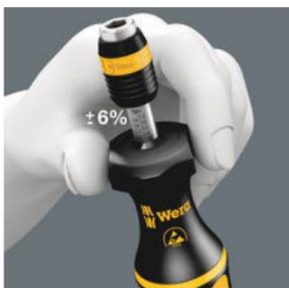
Погрешность  $\pm 6\%$  (артикул 1430:  $\pm 10\%$ ) по стандарту DIN EN ISO 6789. Слышимый и ощущаемый щелчок по достижении установленного крутящего момента.
