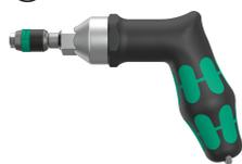
Серия 7400 Динамометрические отвёртки Kraftform, с заводской уставкой значения момента затяжки (0,1-1,5 Nm), с быстрозажимным патроном Rapidaptor, длина ручки 89 мм, 7464 x 3,3 Nm x 3,0-6,0 Nm
