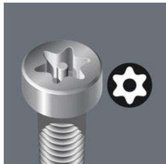
Создан для предотвращения несанкционированного отвинчивания т.н. специального крепежа. Чтобы не допустить использования обычных инструментов TORX®, у винтов в приводном профиле имеется выступающая цапфа. Она входит в отверстие инструментов TORX® BO, и специальный крепеж можно отвинтить. Такие специальные резьбовые соединения используются, например, во многих электрических устройствах, они могут сниматься для ремонта исключительно обученным персоналом.
