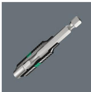
У держателей BiTorsion от компании Wera имеется торсионная пружина, которая амортизирует небольшие пики нагрузки при завинчивании. Совместное использование с насадкой BiTorsion и ее торсионной зоной значительно увеличивает срок службы инструмента. Держатели BiTorsion от компании Wera могут также применяться с обычными насадками.
