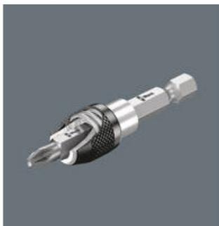
Быстрозажимной держатель обеспечивает прочное и стабильное соединение с насадкой, которое можно легко нейтрализовать. Держатель сконструирован таким образом, что для замены бита нужно просто сдвинуть внешнюю гильзу вперед, чтобы легко установить и извлечь насадку. С магнитом - для более легкого наживления винта.
