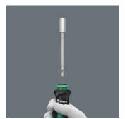
Если повторно нажать на гильзу со слышимым и ощутимым преодолением сопротивления стопорного механизма, происходит его разблокировка. Выдвижной стержень можно извлечь и использовать в качестве адаптера в машинном режиме или вернуть в исходное положение.
