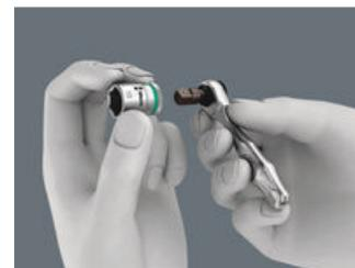
Биты и насадки можно устанавливать напрямую. Также сначала можно установить держатель, который будет фиксировать бит. Держатель также служит удлинителем с муфтой свободного хода. Для насадок понадобится адаптер ¼" для перехода с шестигранника на квадрат, например, Wera 870/1 (имеется в наборе Bit-Check и с отдельными ручками-трещотками входит в комплект поставки).
