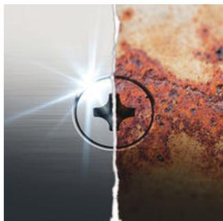
Нержавеющая сталь устойчива против коррозии. Если же для элементов или винтов из нержавеющей стали используется инструмент из обычной стали, продукты износа этих инструментов могут прилипнуть к поверхности и вызвать ржавчину. Эта т.н. контактная ржавчина наряду с визуальными дефектами может вызвать также конструктивные повреждения, исправление которых стоит значительных затрат. Налет ржавчины можно предотвратить, используя инструменты из нержавеющей стали.
