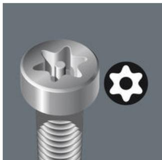
Создан для предотвращения несанкционированного отвинчивания т.н. специального крепежа. Чтобы не допустить использования обычных инструментов TORX®, у винтов в приводном профиле имеется выступающая цапфа. Она входит в отверстие инструментов TORX® B0, и специальный крепеж можно отвинтить. Такие специальные резьбовые соединения используются, например, во многих электрических устройствах, они могут сниматься для ремонта исключительно обученным персоналом.
