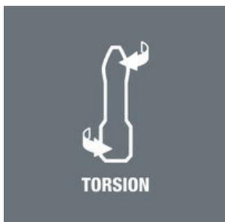
Насадки Torsion (T) обеспечивают амортизацию пиков крутящего момента в зоне кручения. Это позволяет избежать преждевременного износа и продлить срок службы насадки.
