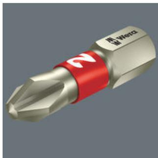
Благодаря применению насадок из нержавеющей стали предотвращается возникновение ржавчины на винтах или поверхностях из нержавеющей стали. Контактная ржавчина на нержавеющей стали появляется, прежде всего, за счет использования при завинчивании обычных стальных инструментов. Вследствие чего остаются прилипшие частицы стали, которые превращаются в ржавчину под воздействием кислорода.
