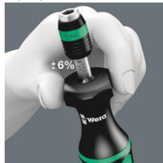
Простая установка требуемого значения момента затяжки вручную. Погрешность  $\pm 6\%$  по стандарту EN ISO 6789. Слышимый и ощущаемый щелчок по достижении установленного крутящего момента.
