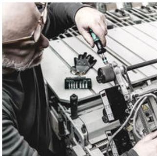
Многие виды винтовых соединений при монтажных и сервисных работах требуют затяжки винта с контролируемым моментом затяжки, чтобы предотвратить повреждение винта или заготовки и обеспечить надежность соединения. Регулируемые динамометрические отвертки от компании Wera являются идеальным решением для таких случаев: Диапазон моментов затяжки от 0,3 Нм до 8,8 Нм, две различные ручки, погрешность  $\pm 6\%$ , молниеносная смена насадки с помощью системы Rapidaptor.
