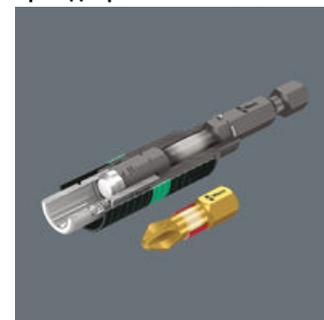
Оптимально согласованные характеристики торсионных зон бита и держателя обеспечивают ступенчатую амортизацию пиков нагрузки. Двухступенчатая система предотвращает преждевременный износ. Кроме того, твердость насадок, предназначенная для соответствующих условий применения, также гарантирует долгий срок службы инструмента.
