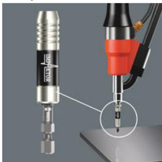
Держатели Impaktor из нержавеющей стали со стопорным кольцом и магнитом отвечают самым строгим требованиям по динамическим параметрам, поскольку в них сознательно не используются механически непрочные мелкие детали. Они служат исключительно для выполнения необходимой функции фиксации бита и смягчения высоких импульсных скачков за счет наличия двух разных торсионных зон. Эти держатели предназначены прежде всего для промышленного монтажа и завинчивания, например, с помощью промышленных роботов.
