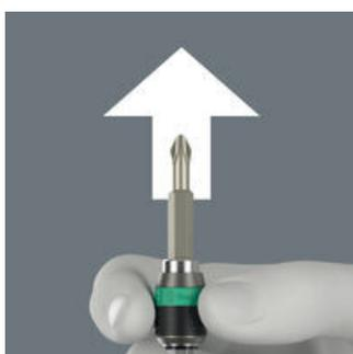
Для смены насадки необходимо просто сдвинуть втулку вперед: при этом пружинный механизм приподнимет насадку с магнита и разблокирует инструмент. Насадка легко извлекается. Отличная помощь: насадки даже минимальных размеров легко извлекаются без вспомогательного инструмента.
