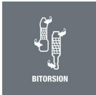
Возникающие при машинном завинчивании пики нагрузки способствуют преждевременному износу насадок или разрушению винтов. Если эти нагрузки свести к минимуму, завинчивание станет более продуктивным и надёжным. Система Wera BiTorsion защищает от преждевременного износа. Срок службы инструмента увеличивается, значительно возрастает производительность при машинном завинчивании.
