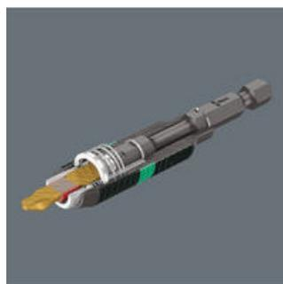
Принцип действия системы BiTorsion основывается на комбинации двух пружинных элементов, поглощающих удары. Как у насадок, так и у держателей имеется специальная зона скручивания, в которую при пиковых нагрузках передается кинетическая энергия из ведомого наконечника.
