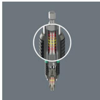
Встроенные в держатель BiTorsion пружины кручения обеспечивают амортизацию небольших пиков нагрузки (фаза 1). Перегрузка этих пружин эффективно предотвращается опорным механизмом.
