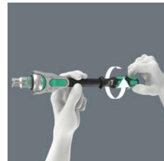
Трещотки Zyklop Speed являются настоящими чемпионами по скорости: Конструкция, использующая инерционную массу, обеспечивает ускорение процесса завинчивания. Вращательно-симметричная конструкция рукоятки Kraftform и муфта свободного хода поддерживают стремительное вращение. В особенности тогда, когда трещотка не входит в зацепление из-за слишком свободной резьбы отвинчиваемой детали.
