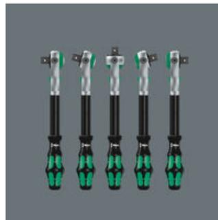
Головка трещотки свободно поворачивается и благодаря расположенным с обеих сторон сдвижным переключателям может блокироваться в любом положении. Таким образом, даже в узких и труднодоступных местах Вы можете выполнять работы без проблем и достаточно свободно. Фиксация в определенных положениях под углом 0°, 15° и 90° влево и вправо гарантирует уверенную работу с надежно зафиксированной трещоточной головкой.
