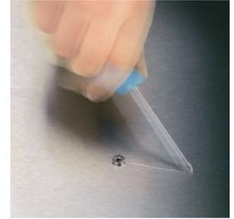
Часто при завинчивании отвертка выскользывает из винта. Иногда при этом повреждается ценная поверхность или дело даже кончается травмой. В отвертках Wera наконечник Lasertip обработан лазером до микроскопической шероховатости. Такая шероховатая поверхность буквально "врезается" в головку винта. О случайном соскальзывании отвертки можно забыть.
