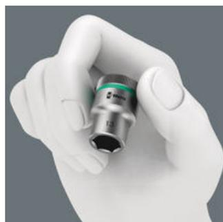
Головки Zyklor подходят для ручного и машинного инструмента (неударного действия). Они снабжены канавкой под шариковый фиксатор и рифлением по заднему краю для уверенного хвата при использовании головки в ручном режиме. Изготовлены из хромованадиевой стали, с матовым хромированным покрытием. Идентификатор инструмента Take it easy: цветовая маркировка по размеру, а также гравировка размеров помогут вам быстро и легко найти нужную головку.
