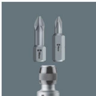
Быстрозажимной держатель обеспечивает прочное и стабильное соединение с насадкой, которое можно легко нейтрализовать. Держатель сконструирован таким образом, что для замены бита нужно просто сдвинуть внешнюю гильзу вперед, чтобы легко установить и извлечь насадку. Исполнение без магнита - для предотвращения нежелательного налипания металлических стружек.
