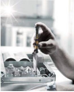
Привинчивая электронные компоненты (например, в смартфонах или планшетах), нельзя допускать электростатических разрядов, поскольку они могут вызвать различные сбои электроники, вплоть до её полного выхода из строя. По этой причине обязательным условием является использование отверточных инструментов с электростатической защитой.
