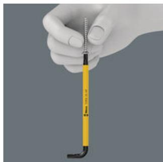
В труднодоступных местах (например, в моторном отсеке) невозможно зафиксировать рукой винт на отвертке. Часто винт куда-то падает. Затем следует утомительный поиск или потеря винта (и, возможно, связанные с этим риски). Разработанные фирмой Wera инструменты TORX® HF улучшают геометрию профиля TORX®. Благодаря силе прижима, создаваемой поверхностным напряжением между профилем винта и наконечником, винт надежно удерживается на инструменте!
