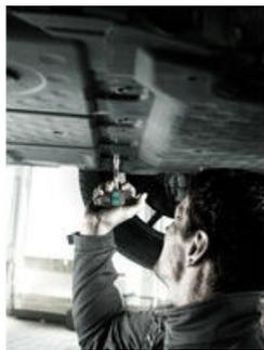
Поперечная ручка 411 A RA подходит для торцовых головок 1/4". Головки надёжно удерживаются шариковым фиксатором.
