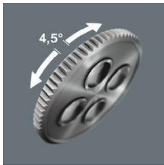
Встроенная трещотка с тонким механизмом зацепления (80 зубцов) и углом возврата 4,5° упрощает и ускоряет завинчивание без утомительного перекидывания.
