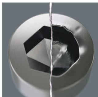
Проблема винтов с внутренним шестигранником состоит в том, что опорные поверхности, передающие усилие с отвёртки на винт, очень узкие. Поэтому головка винта может разрушаться. Отвёртка с профилем Hex-Plus имеет довольно большую опорную поверхность, которая препятствует этому! Полезно знать: инструменты Hex-Plus подойдут к любому стандартному винту с внутренним шестигранником.
