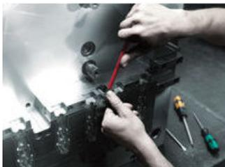
Мы просто подвергли сомнению классические Г-образные ключи, поскольку во время работы они слишком часто скругляют профиль головки винта. После этого винты не подходят для дальнейшего использования и ключ проскальзывает. Инструменты Wera Hex-Plus обладают увеличенной площадью контакта с головкой винта. Разрушающие силы и связанная с этим деформация профиля головки винта снижаются. Одновременно можно почти на 20 % повысить передачу момента силы.
