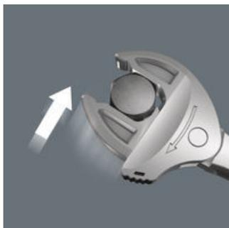
Двусторонний рожковый гаечный ключ Joker 6006 с автоматическим и непрерывным захватом параллельными губками подходит для всех размеров в пределах рабочего диапазона. Инструмент сам и без регулировки выбирает нужный размер при накидывании на гайку или винт.
